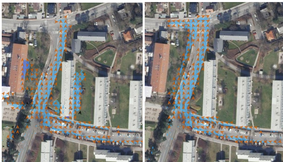
Figur 6.2: Oversvømmelse ved krydset mellem Lundtoftevej og Nøjsomhedsvej uden (venstre) og med tiltag (højre).
