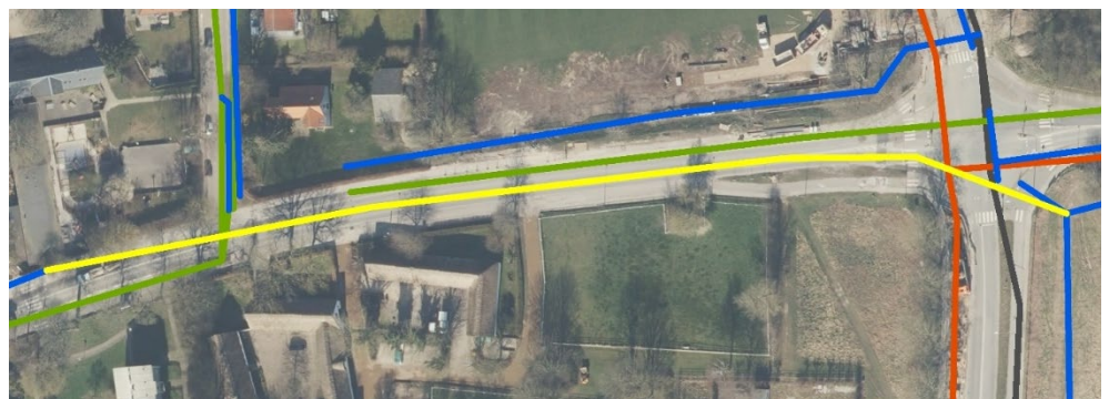
Figur 5.2: Ny regnvandsledning på Ø800 mm i Lundtoftevej
