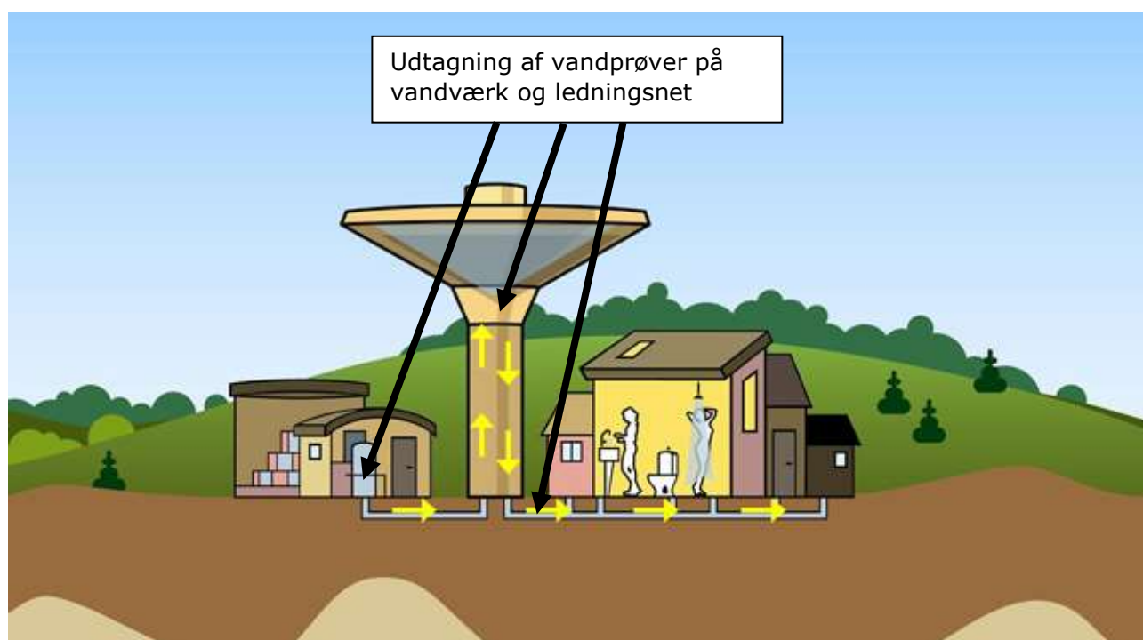
Figur 3. Illustration af vandprøvetagning på vandværker og ledningsnet.
