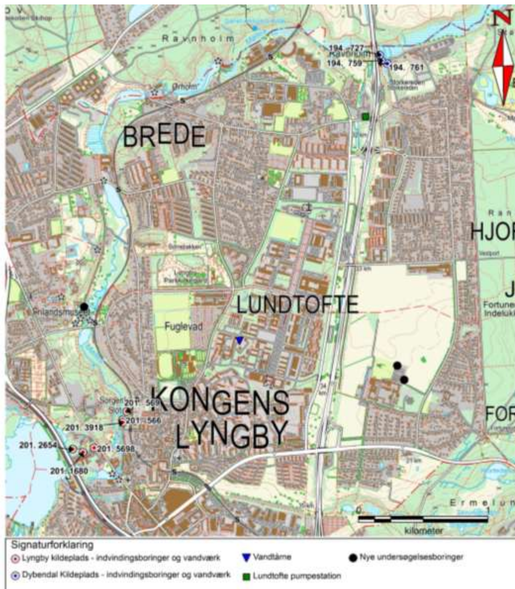
Figur 1. Oversigtskort med placering af kildepladser, vandtårn, pumpestation og undersøgelsesboringer.
